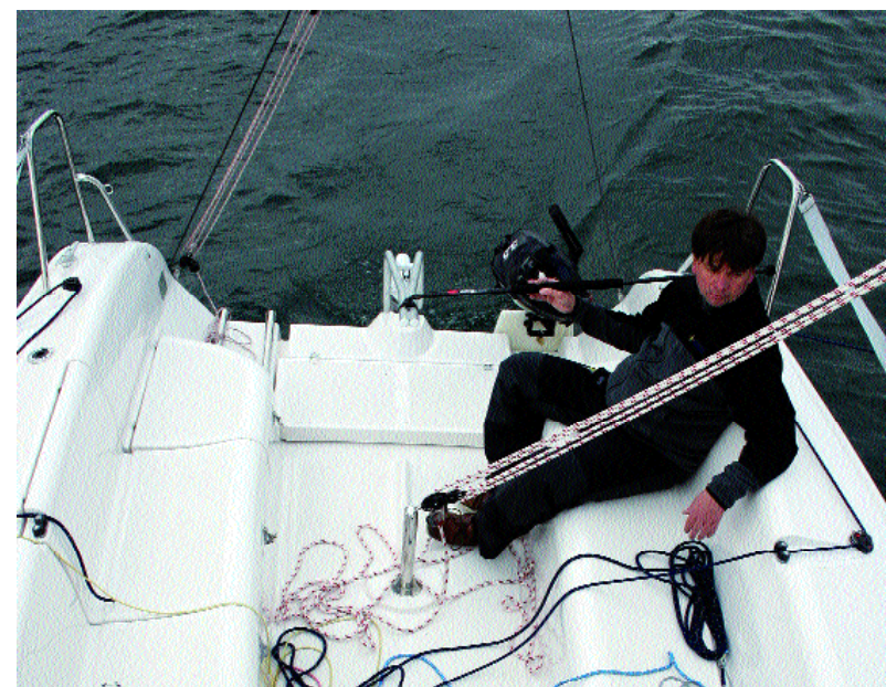
Das Cockpit ist geräumig und gut dimensioniert. Der Spiegel ist offen.
