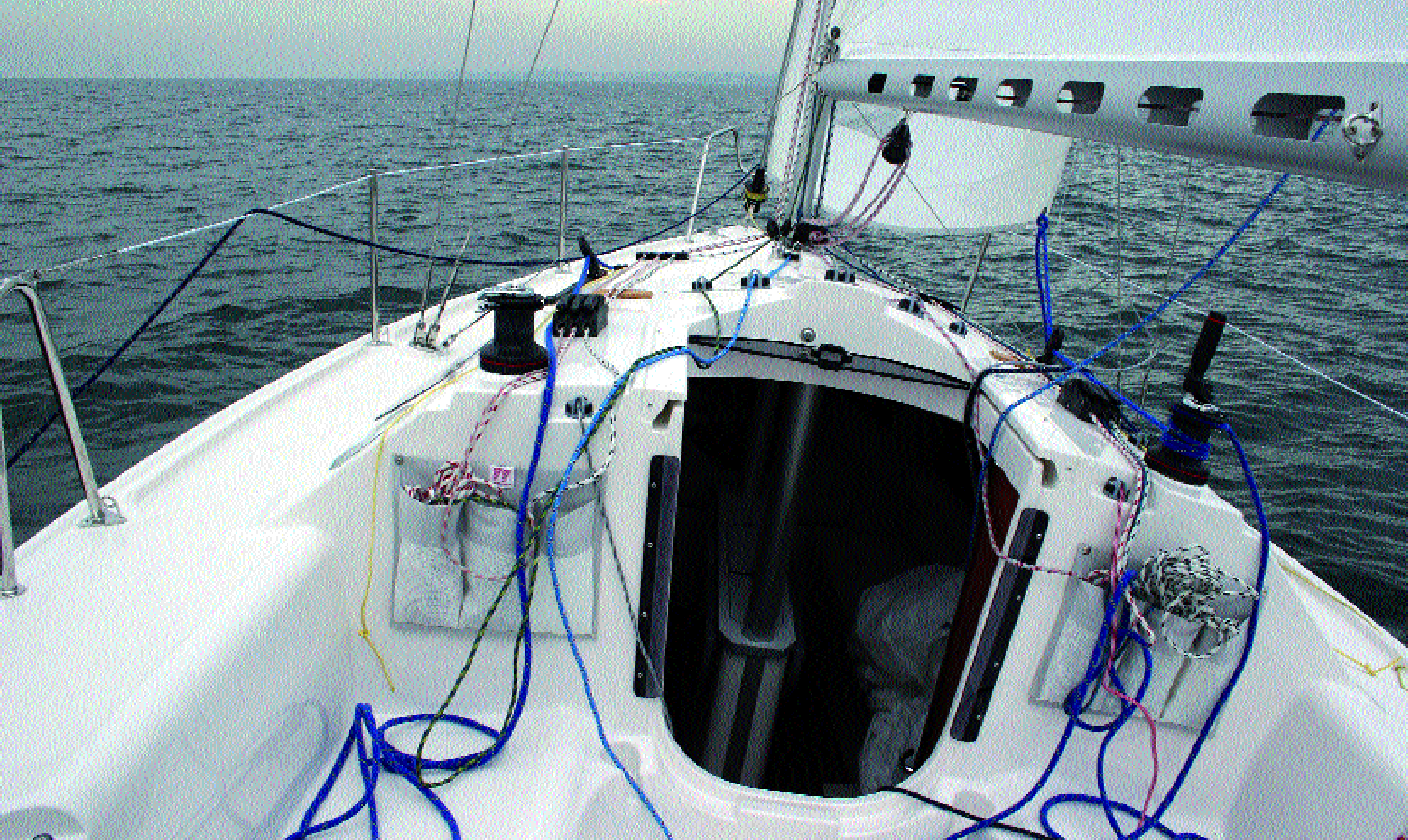
Das Decklayout ist übersichtlich und die Ausrüstung kommt vorwiegend von Ronstan und Harken. Unter Deck ist der Kielkasten zu sehen. Der Gennaker wird in den Niedergang geborgen.
